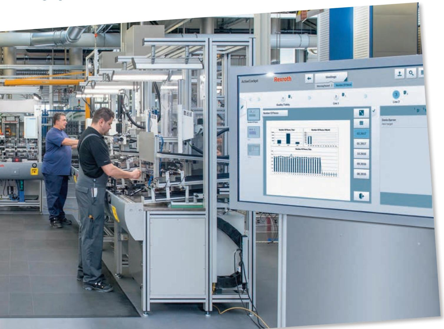
**Zur besseren Bewältigung der Datenvielfalt stattete Bosch Rexroth bereits 2014 eine erste Industrie 4.0-Montagelinie mit interaktiven Touchscreens und der ActiveCockpit-Software aus.**
