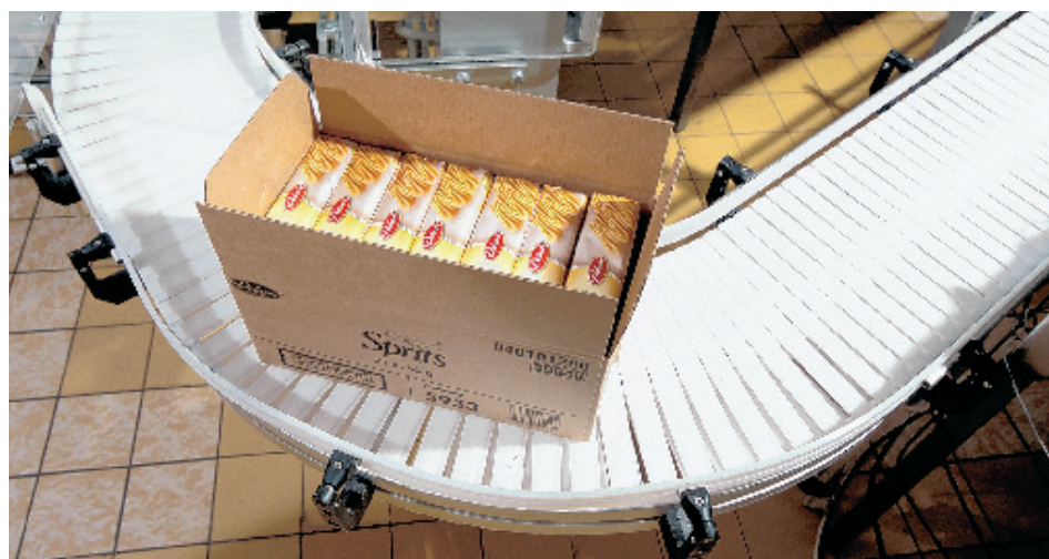
Die Kartons mit einzelnen Gebäckpackungen werden auf einer 320 Millimeter breiten Kette, ebenfalls aus dem VarioFlow-S-Programm, befördert. Ein solcher Radius unmittelbar nach der Verpackungsmaschine lässt sich nur dank der integrierten Lagerung und somit ohne Kurvenrad realisieren
