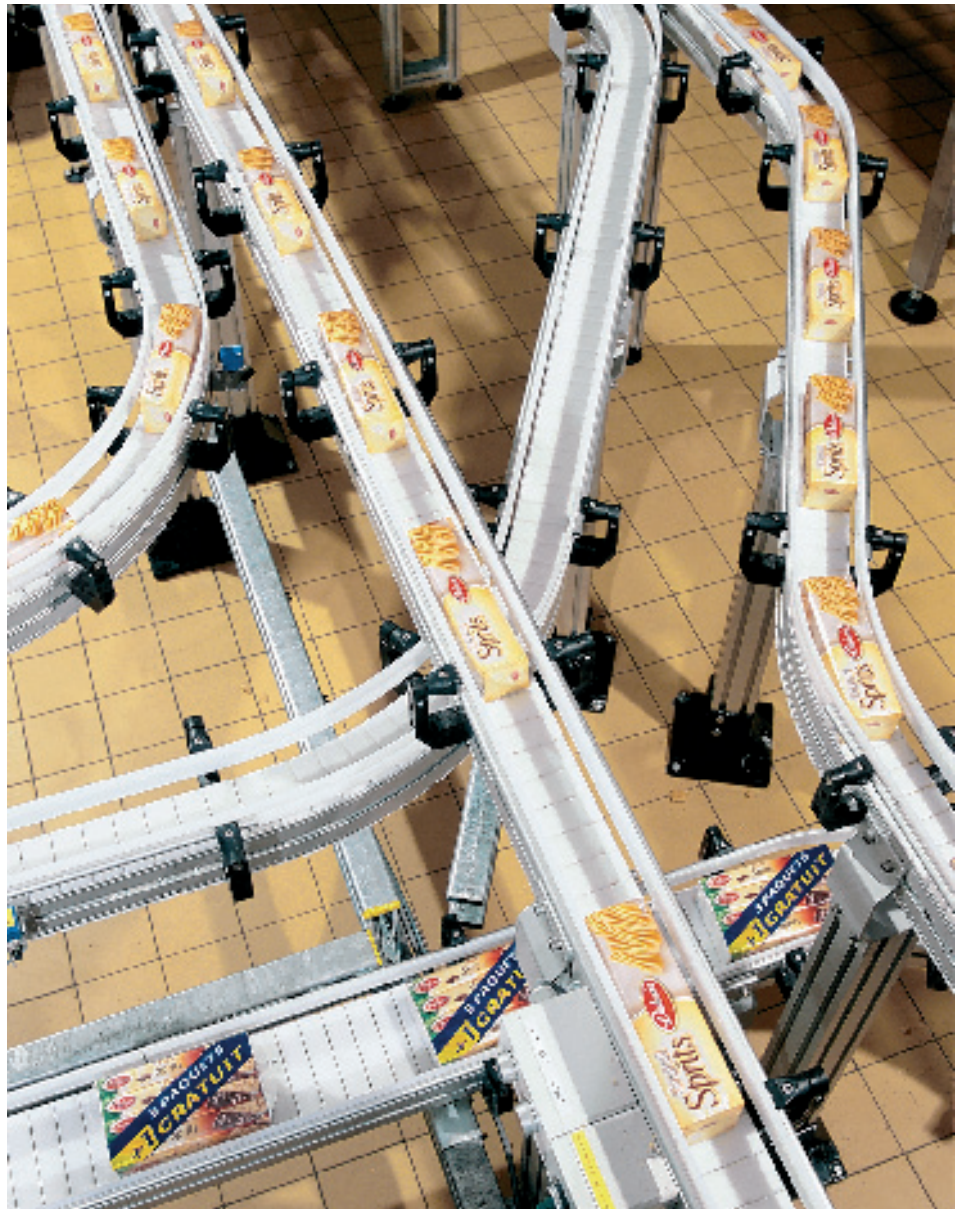
Das Layout der Förderstrecke gleicht an manchen Stellen einer Achterbahn. Je nach Packungseinheit setzt United Biscuits verschiedene Breiten ein: die 80 Millimeter breiten Ketten für Einzelverpackungen und die 160 Millimeter breiten Ketten für den Dreierpack
